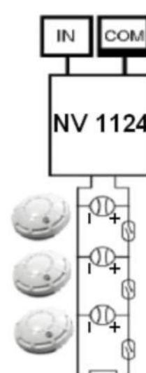
шлейф пожарных двухпроводных извещателей
